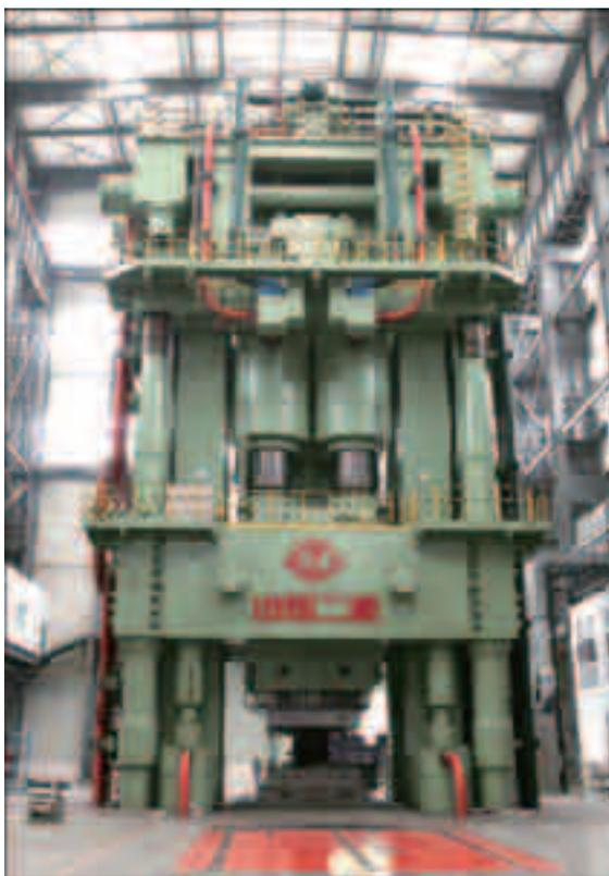
图 6-7 8 万吨大型模锻压机
