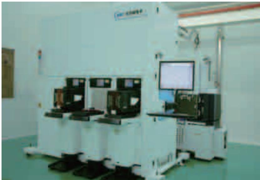
图 6-5 北方微电子的硅刻蚀机
