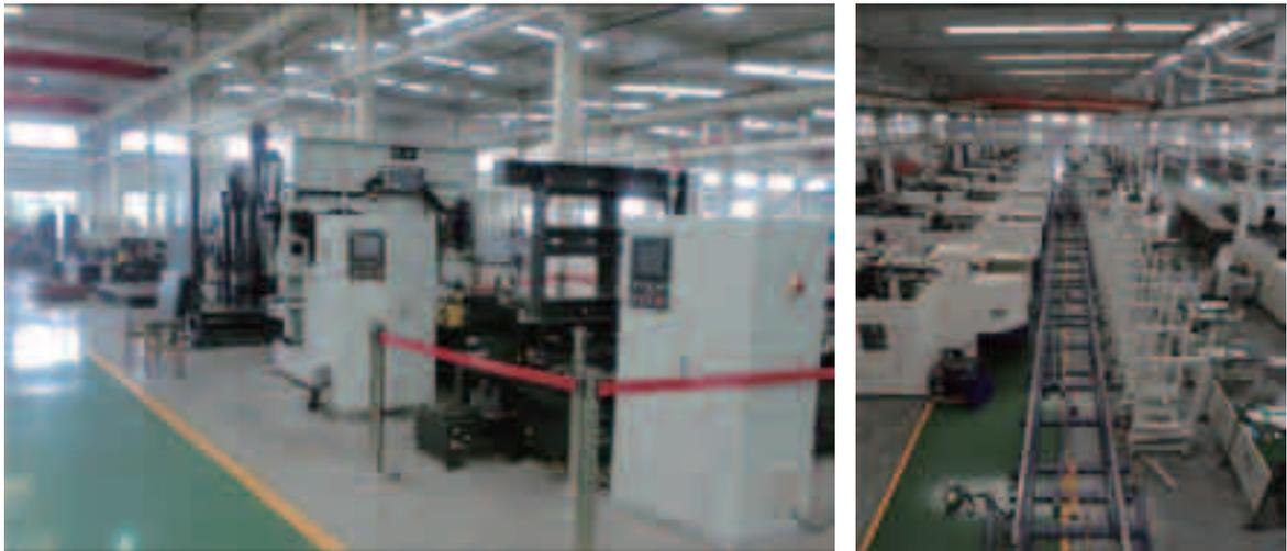
图 6-6 普什宁江精密卧式加工中心（左）和汽车变速器壳体生产线（右）
